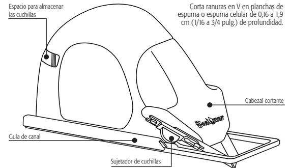
**Espacio para almacenar las cuchillas:** está ubicado en la parte trasera de la herramienta y se utiliza para guardar las cuchillas de repuesto.
