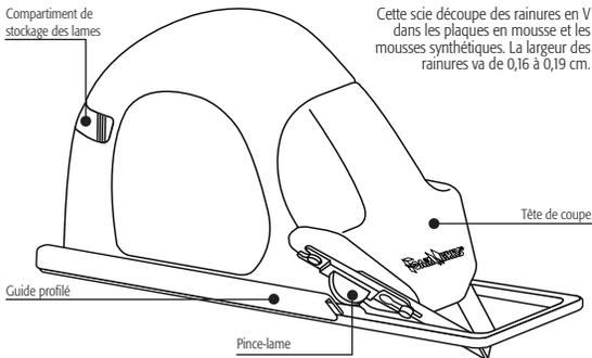
**Compartment de stockage des lames:** Situé à l'arrière de l'outil, il est utilisé pour stocker les lames de rechange.
